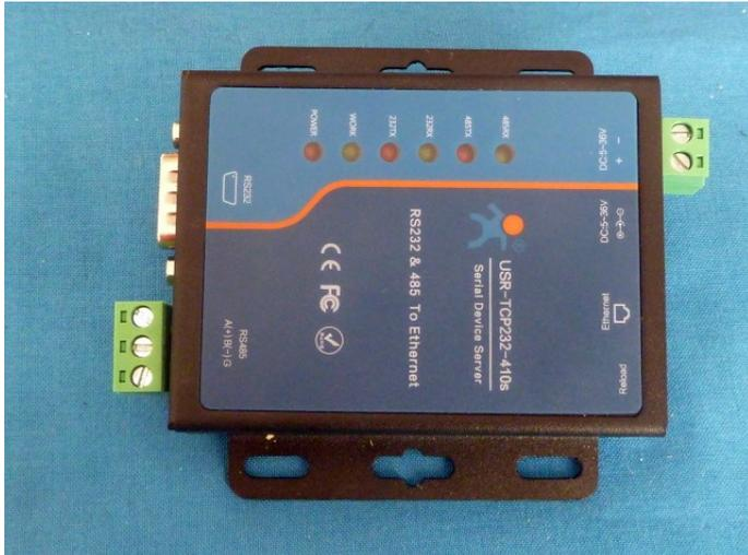
Abbildung 11: Zweikanaliger Ethernetwandler mit RS232- und RS485 Eingang
