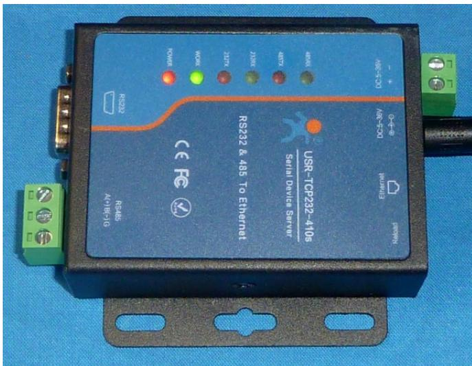
Abbildung 42: USR-TCP232-410S kann 2 Kanäle gleichzeitig verarbeiten. Einen RS232 Eingang und einen RS485 Eingang. Ein schönes Fertigmodul im Metallgehäuse
