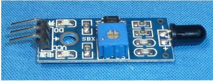
Abbildung 25: IR Flame Sensor Modul, hier mit 3 Anschlüssen, was für unsere Zwecke ausreicht. Bei dem gezeigten Modul muß der Phototransistor, der rechts über das Modul herausragt, ausgebaut werden und dann nach unten gerichtet wieder eingebaut werden.
