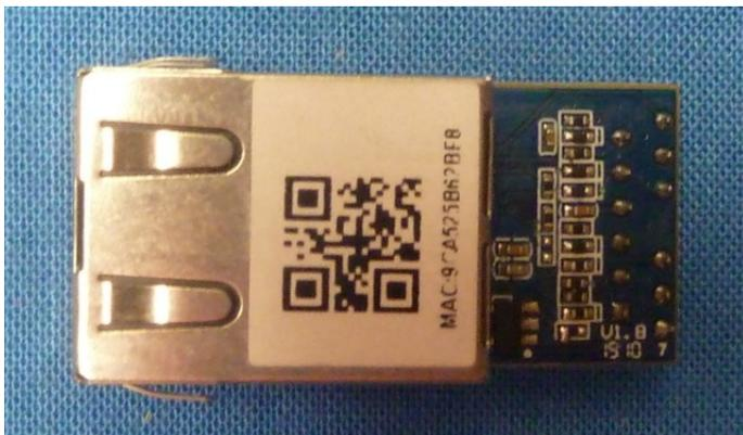
Abbildung 40: USR-K7-Modul. Kleines einkanaliges kompaktes Auflötmodul mit kräftigerem Rechner. Kaum größer als eine RJ45 Buchse
