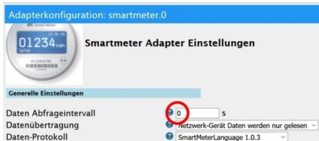
Abbildung 18: Während der Positionierung des Lesekopfs maximale Abtastrate durch Eintragen der 0 wählen
