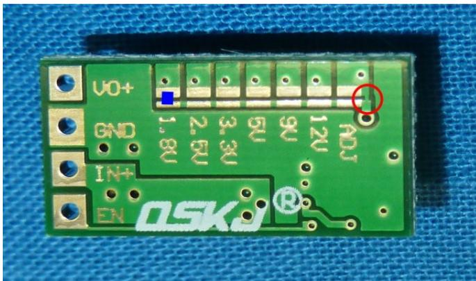
Abbildung 53: Zur Nutzung der Festspannungsbrücken muß die rot umrandete Leiterbahn durchtrennt werden
