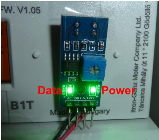
Abbildung 12: So kann ein kostengünstiger Lesekopf im Rohzustand aussehen. Ein isolierendes Gehäuse ist vorzusehen
