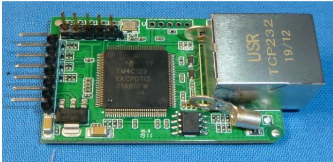
Abbildung 39: Das USR-TCP232-E2 Modul hat 2 Eingänge. Ich verwende einen Eingang für RFLink und einen für den Smartmeter. Die Steckerleisten und die Kabelösen zur mechanischen Befestigung sind nicht original
