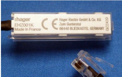
Abbildung 15: Hager EHZ001K eignet sich als Sensorkopf, wenn eine Installation mechanisch machbar ist. Als Schnittstellen sind RS232 und RS488 vorhanden. Dafür gibt es Wandler nach USB, Ethernet, WLAN
