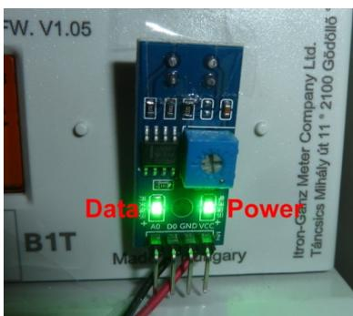
Abbildung 17: Die billige Selbstbaulösung im Testeinsatz. Ein Magnet auf der Unterseite hält den Lesekopf in Position
