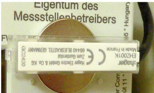
Abbildung 16: Hager EHZ001K bei einer Testinstallation mit einem Ringmagneten.
