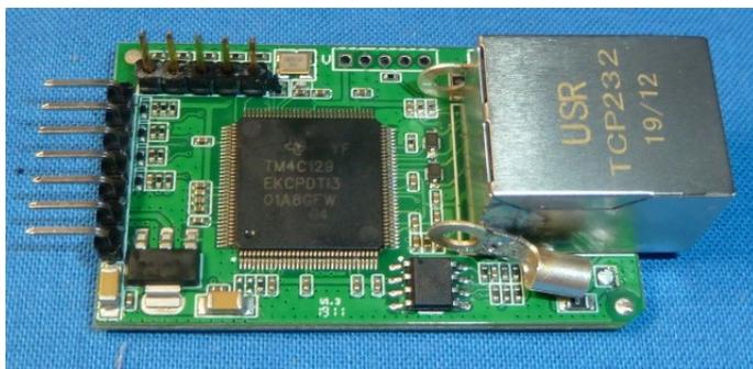
Abbildung 13: Zweikanaliges Ethernet-Wanlermodul USR-TCP232-E2
