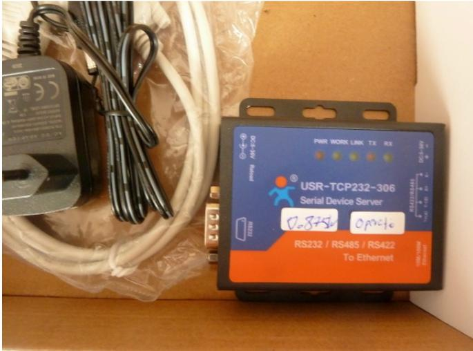
*Abbildung 43: Typischer Lieferumfang der USR Fertigeräte hier am Beispiel des USR-TCP232-306: Gerät, RS232 Nullmodemkabel, Netzteil*
