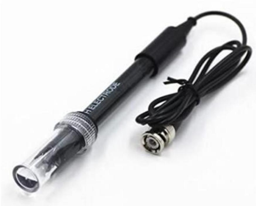
Die PH-Elektrode hat einen einzelnen Zylinder, der den direkten Anschluss an den Eingangsanschluss eines PH-Messgeräts, Controllers oder eines anderen PH-Geräts mit BNC-Eingangsanschluss ermöglicht.
